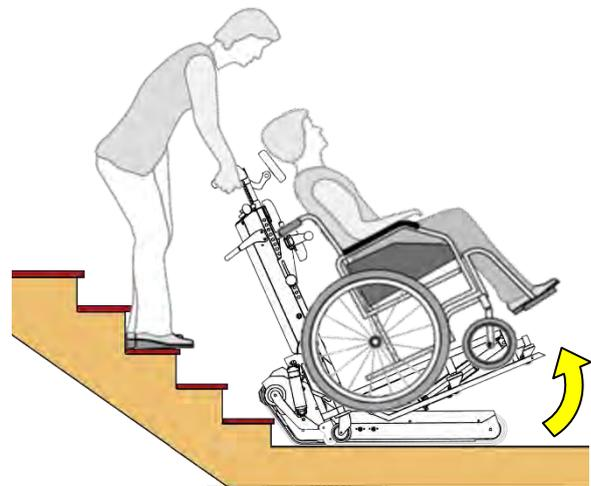
8. Drücken Sie vor Beginn der Auffahrt auf die Taste für die Neigung der Treppe, um die Rückenlehne des Geräts leicht nach hinten zu neigen. Auf dem Display wird die Wasserwaage mit der momentanen Neigung in Grad angezeigt. Denken Sie daran, die Anzeige immer auf Grün zu stellen (wie in der Abbildung), damit der Schwerpunkt der Körper und des Geräts so zentral wie möglich ist.
