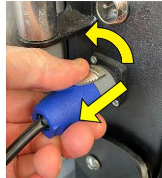
3. Schließen Sie den Stecker A des Akkuladegeräts an das Stromnetz an.
