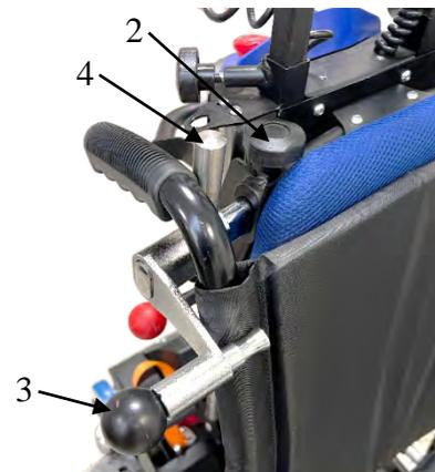
7. Lösen Sie die federbelasteten Klappen (3), indem Sie sie nach außen ziehen und um 90° drehen. Dadurch bleiben die Klappen in der geöffneten Position verriegelt.
