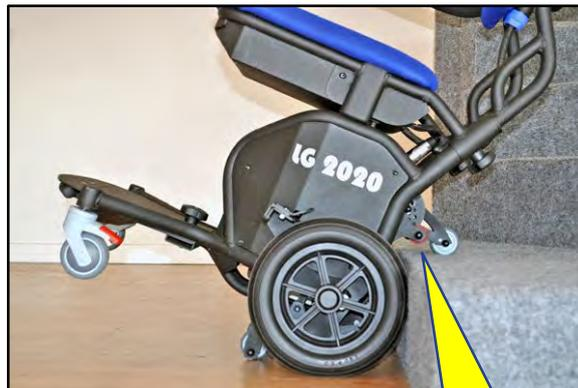
Dieses Rad muss auf die Stufe aufsetzen.
