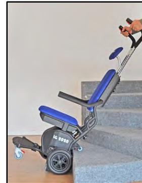
11. Bewegen Sie das Gerät näher an die erste Stufe heran, bis die Hinterräder die Trittstufe berühren.
