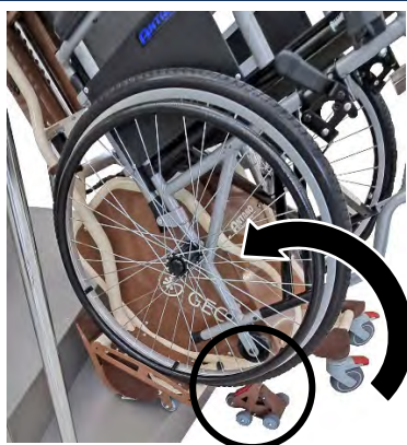
Das mechanische System positioniert das Gerät auf der 1. Stufe.
